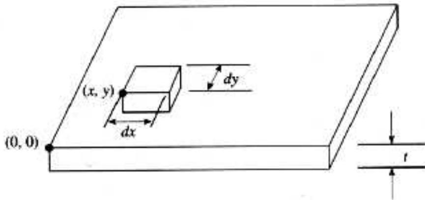
Soit  $u$  représentant la température dans l'élément de taille  $dx \times dy$  à l'état stable ( $\text{tps} \rightarrow \infty$ )
