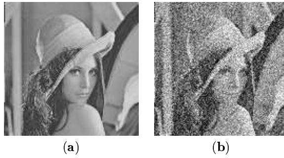
FIG. 2 – (a) Image originale lenna.pgm . (b) Image bruitée par un bruit “blanc” gaussien de variance \sigma^2 = 1000 .
